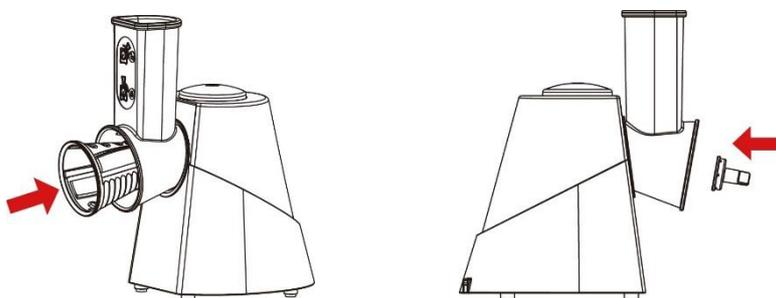
Поверните винт влево, чтобы закрепить лезвие. Для отсоединения лезвия поверните винт вправо, затем извлеките винт и лезвие.
