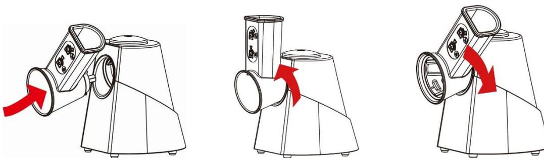
Выберите необходимое лезвие и установите его в отверстие горловины. Чтобы фиксировать лезвие установите крепежный винт на вал как показано на рисунке.
