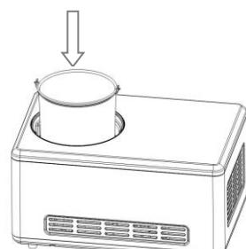
**Шаг 3.** Установите съемную чашу в устройство и слегка нажав, поверните её до плотной посадки в фиксированной чаше.
