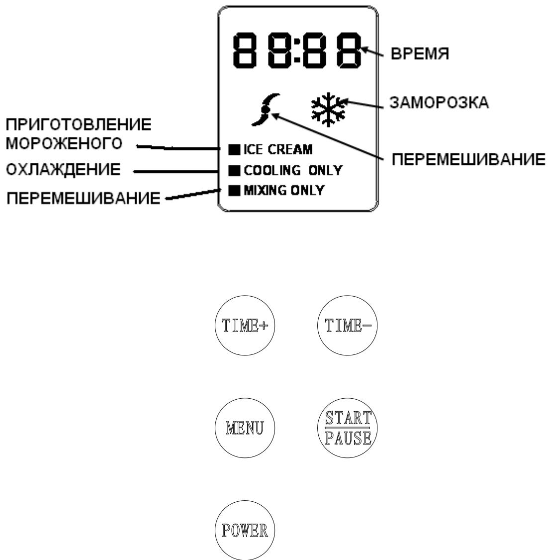
**[POWER «ВКЛ/ВЫКЛ» ]:** После подключения фризера к электросети, аппарат перейдет в режим ожидания и на дисплее появится «00». Нажмите кнопку [POWER], чтобы перейти к выбору настроек. Если Вы нажмете кнопку [POWER] во время работы фризера, то он выключиться.
