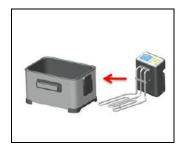
2. Вдвиньте панель управления с нагревающим элементом на боковую часть внешнего металлического корпуса и вдавите их вниз, пока они не встанут в свое усадочное место.
